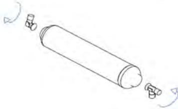
j) Sortez le post-filtre de son emballage original, retirez les bouchons de protection présents sur ses extrémités et placez le nouveau post-filtre à sa place grâce aux brides, en prenant en compte la flèche représentant le sens du flux d'eau. Assurez-vous que le post-filtre est placé dans la direction correcte, en cas d'erreur l'eau n'aura pas un bon écoulement.
